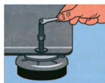
Avvitare o svitare il perno per il posizionamento.
