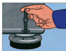
Infilare il perno nel foro della macchina. Avvitare al supporto.
